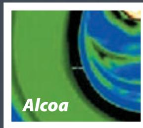
*Wärmebilder zeigen, dass die Lauftemperatur von Alcoa-Aluminiumrädern bei identischen Betriebsbedingungen bis 22°C unter der von Stahlrädern liegt.*
