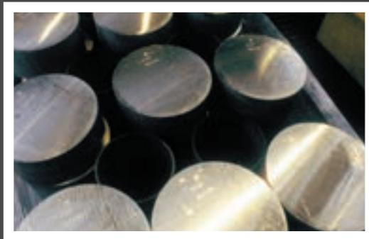
Eine 8000-Tonnen-Pressen schmiedet das Stück in seine Radform. Danach werden die Räder wärmebehandelt, um die mechanische Gesamtfestigkeit zu maximieren.
