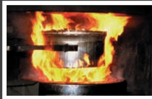
Der Alcoa-Schmiedeprozess richtet den Körperstrom des Aluminiums an der Form des Rads aus, und zwar selbst in dem kritischen Bereich, in dem Scheibe und Felge aufeinander treffen. Das Ergebnis sind Räder mit unübertroffener Schmiedefestigkeit, die auch anspruchsvollste Tests bestehen: TÜV, LBF und JWL-T.
